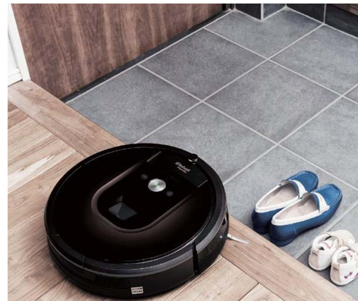
段差を感知して、落下を自動的に回避*2 走行中、進行方向に段差を感知すると、ルートを変更して落下を自動的に回避します。
