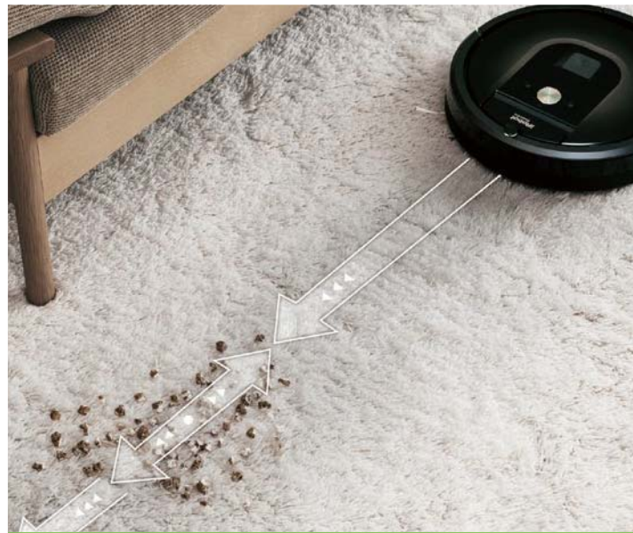
ゴミの多い場所は、キレイになるまで入念に ゴミや汚れが多い場所はセンサーで感知。キレイになったと判断するまで、ブラッシング動作を繰り返し、集中的に清掃します。*1
