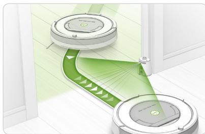
**ライトハウスモード：**お部屋ナビのスイッチを「Lighthouse」の位置に合わせると、ルンバは複数の部屋を順に効率よく清掃して、ホームベースに戻ります。お部屋ナビは各部屋の出入口の端に、前面を反対の端に向けて設置してください。ルンバがひとつの部屋の清掃を終えると、お部屋ナビが次の部屋へ誘導します。お部屋ナビとバーチャルウォールは同時に使用できますが、それぞれの近くや、ホームベースの近くには設置しないでください。また、家具などで見えない壁が遮られない位置に設置してください。
