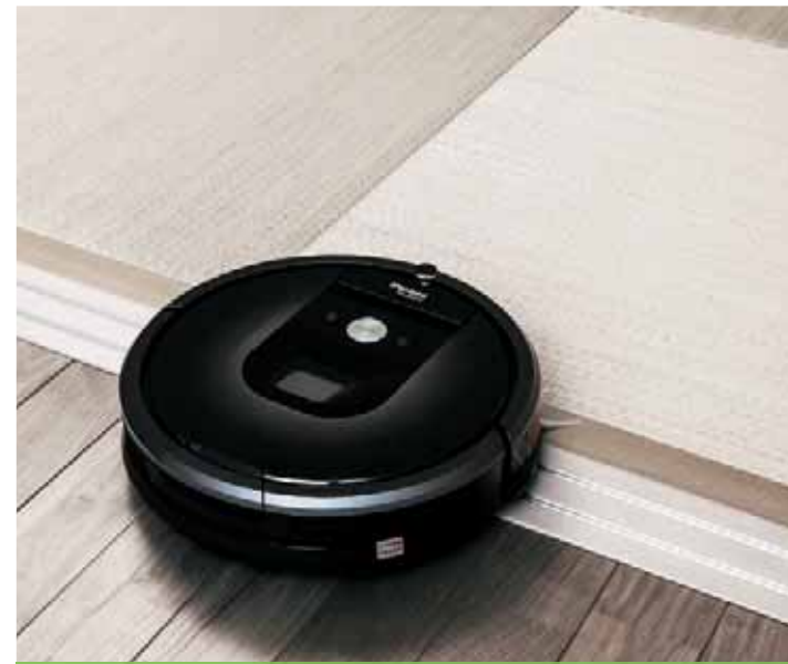
床の種類に合わせて自動調整 フローリングから畳、カーペットなど、床材に合わせて吸引口を最適な状態に調整します。
