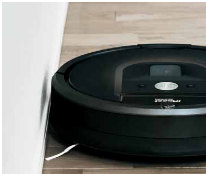
壁ぎわ、カーテンの奥などもしっかりと エッジクリーニングブラシが壁ぎわのゴミをかきだして清掃します。
